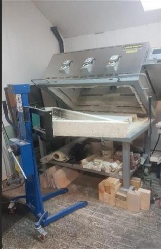
Four de fusing Nabatherm, pour la cuisson et recuisson du verre (le moule est préalablement déciré dans un autre four)
