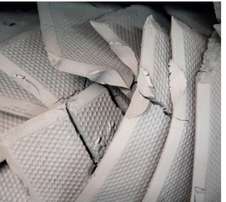
Recyclay est le résultat d'un procédé révolutionnaire de traitement de nos effluents de production qui permet d'épurer l'eau pour la rendre à la nature et de récupérer les matières minérales en suspension, issues de nos pâtes et émaux, pour en faire une nouvelle pâte céramique possédant les mêmes propriétés techniques que les autres céramiques Revol.
